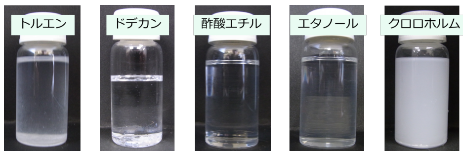
Fig. 1 各有機溶媒中での MTES 被覆微粒子の挙動
