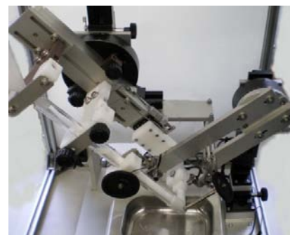
Fig. 2 精密定量供給装置（傾斜排出状態）
