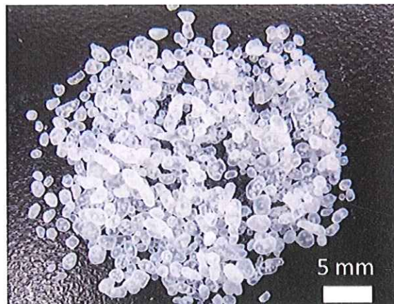
Fig.3. CVP 水溶液 (0.175 wt%) を用いて作製されたリキッドビーズのデジタルカメラ写真
